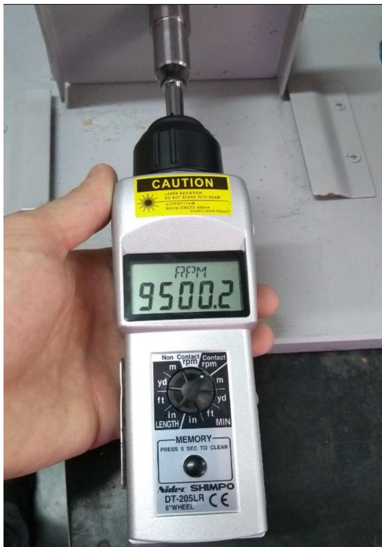
Figura 13 - Tacômetro utilizado para aferição da rotação
