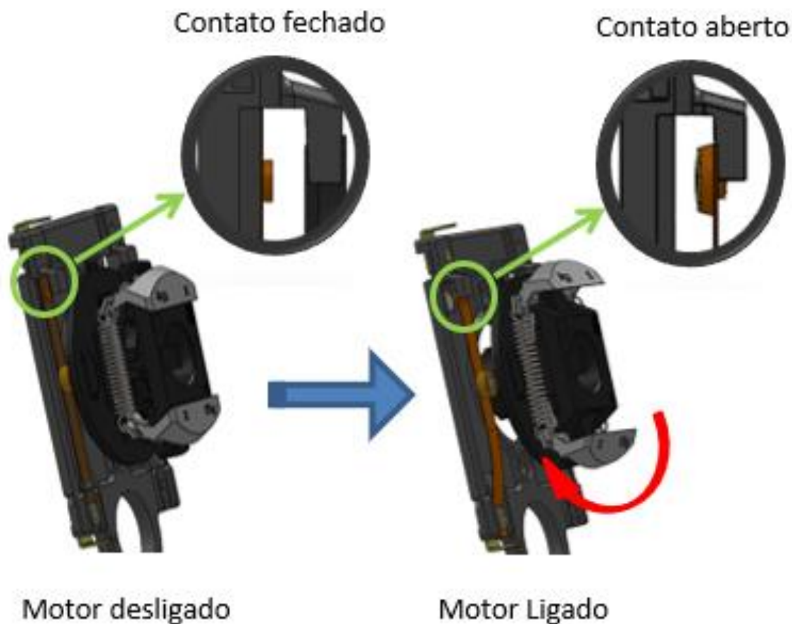
Figura 2 - Esquema funcionamento centrífugo - platinado
