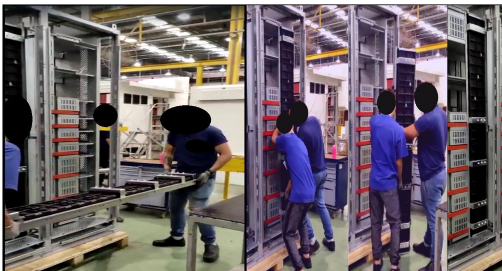
Figura 6: Procedimento de inserção de dutos atual.
