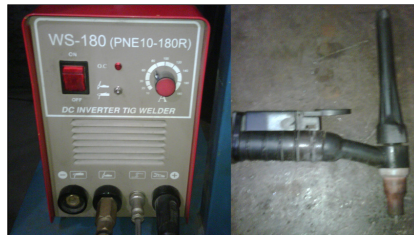
Figura 19 - Fonte de energia e tocha de soldagem Fonte: Autor, 2013
