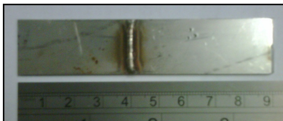
Figura 18 - Corpo de prova soldado e cortado para ensaio
