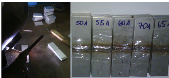
Figura 20 - Processo de soldagem e corpos de prova soldados Fonte: Autor, 2013
