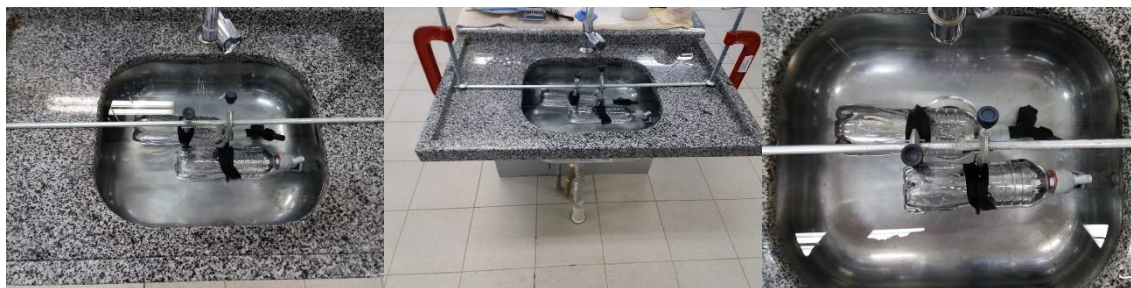
Figura 13 – Teste de estanqueidade
