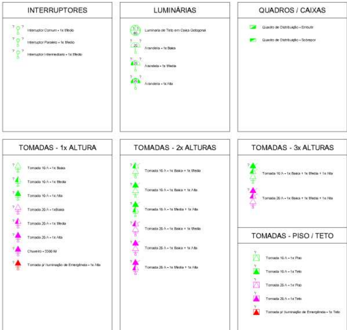
Figura 29 – Blocos dinâmicos criados para o plugin e algumas de suas diferentes visibilidades.
