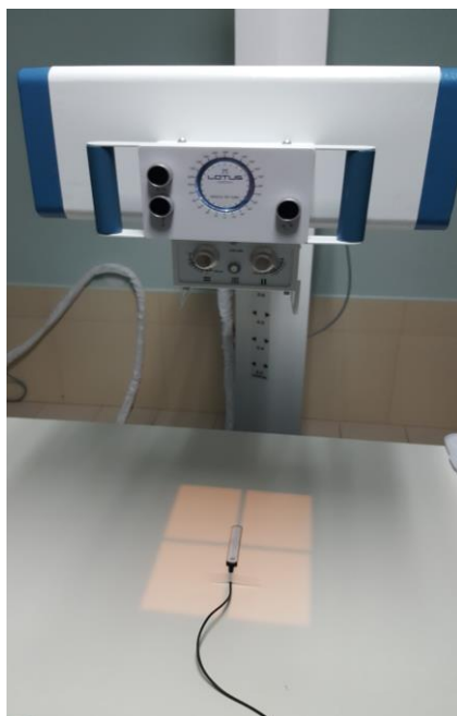
Figura 26 - Sensor do detector posicionado em cima da mesa de exames para leituras de KERMA
