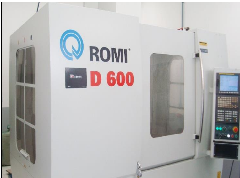
Figura 5- Centro de usinagem ROMI D 600 Fonte: o autor (2014)
