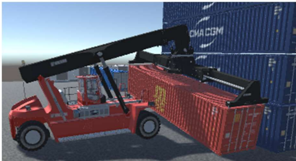
Figura 28. Contêiner mal ovado içado pela máquina.
