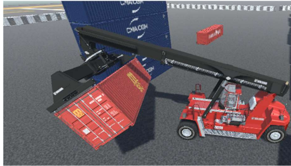
Figura 42. Contêiner mal ovado apoiado no chão e em outra pilha.
