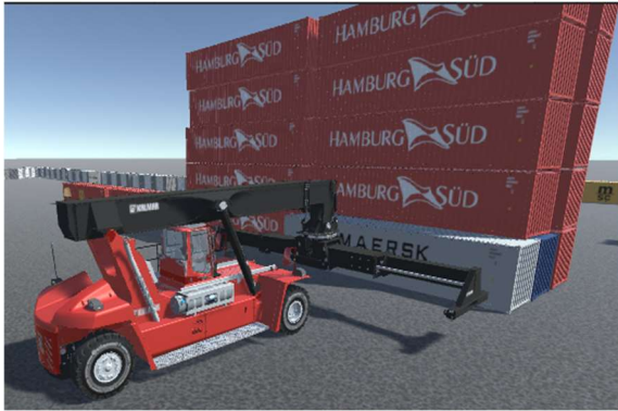
Figura 23. Máquina ajustada para baixar a lança e fazer e acoplamento.
