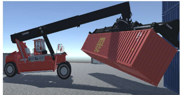
Figura 29. Contêiner mal ovado apoiado no chão e em outra pilha.
