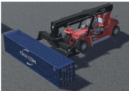
Figura 34. Máquina posicionada para elevar contêiner com os cubos no interior.
