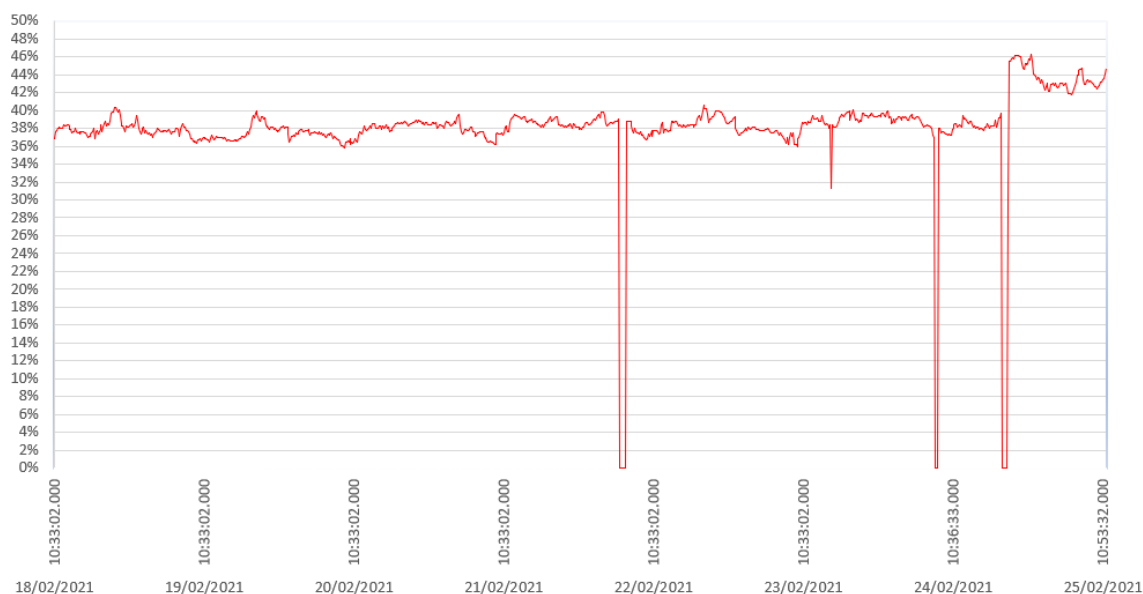
Figura 48 – Distorção Harmônica Total de Corrente na Fase C em 1008 registros válidos
