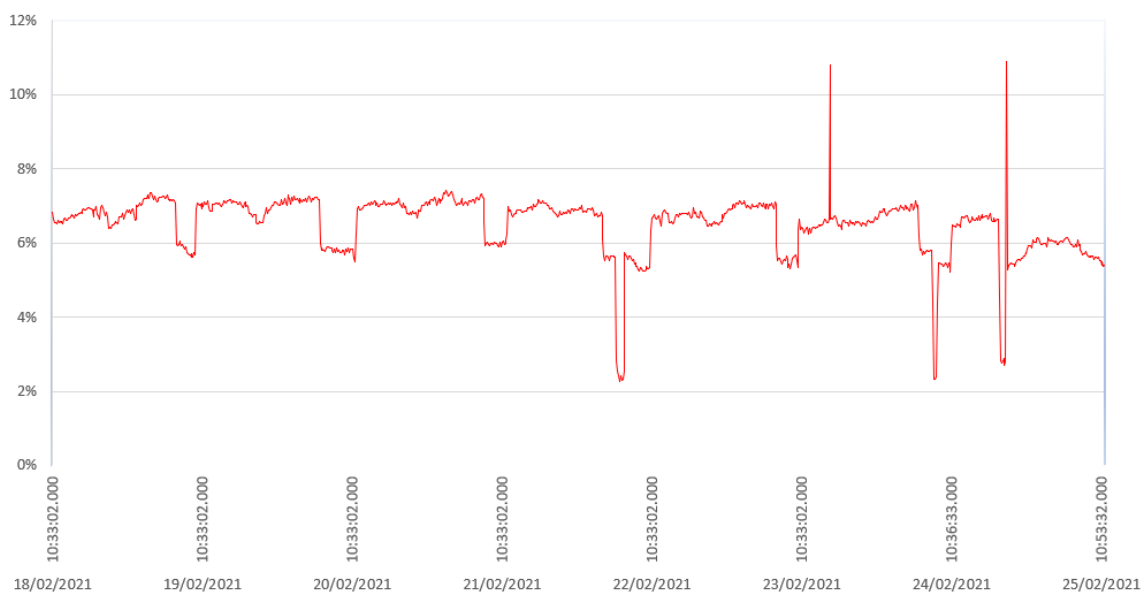
Figura 45 – Distorção Harmônica Total de Tensão na Fase C em 1008 registros válidos
