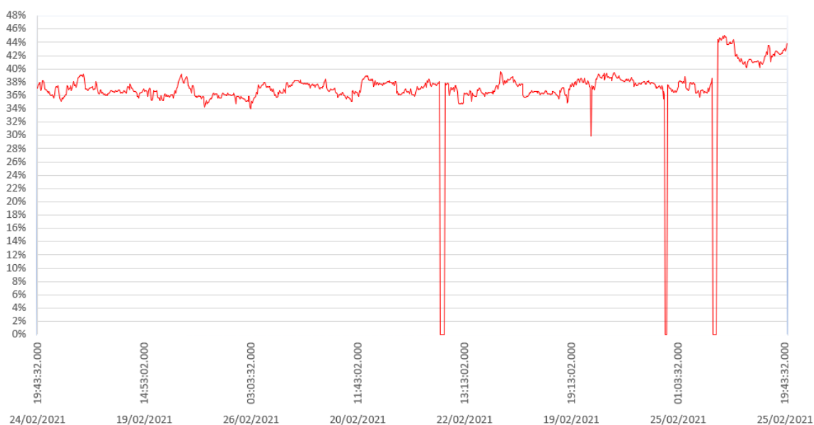
Figura 47 – Distorção Harmônica Total de Corrente na Fase B em 1008 registros válidos
