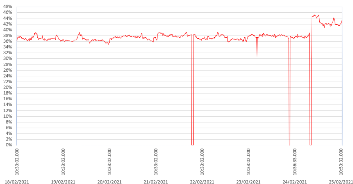
Figura 46 – Distorção Harmônica Total de Corrente na Fase A em 1008 registros válidos
