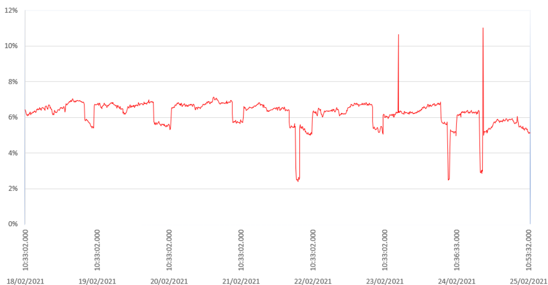
Figura 44 – Distorção Harmônica Total de Tensão na Fase B em 1008 registos válidos
