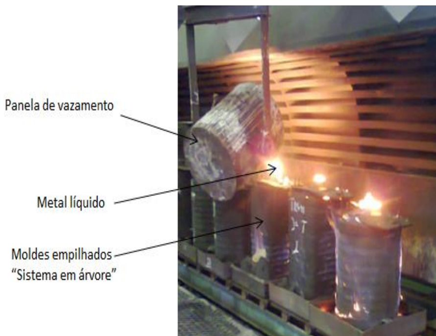
FIGURA 8- Processo de vazamento do metal líquido em moldes de areia
