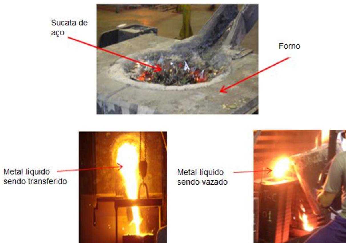
FIGURA 21- Sequência do processo de fusão
