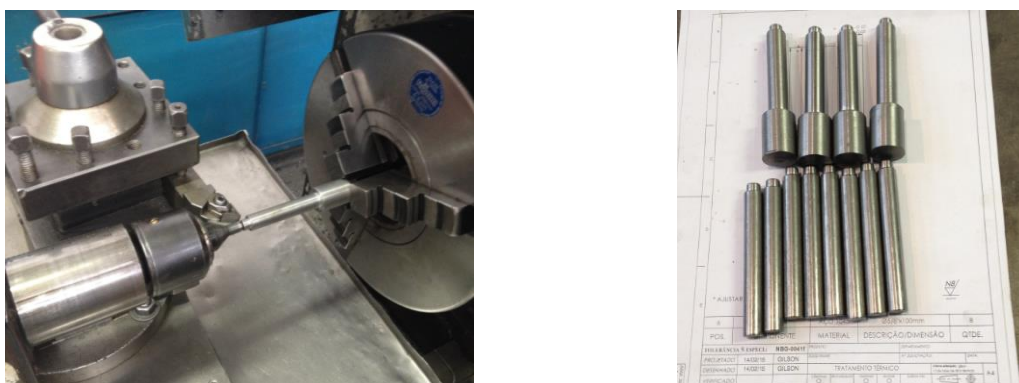
FIGURA 16- Usinagem dos pinos do sistema de extração do modelo
