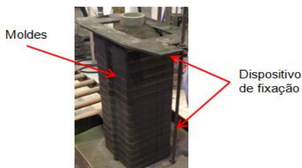
FIGURA 20- Moldes de areia empilhados sistema em árvore
