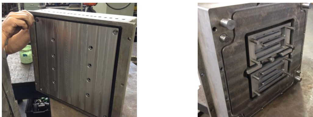
FIGURA 17- Montagem do sistema de extração
