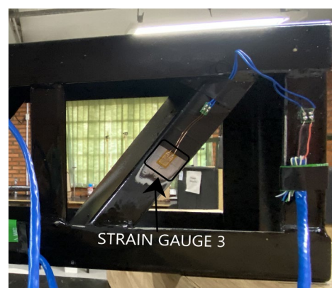
Figura 29: (a) Extensômetros fixados no banzo longitudinal superior e inferior da estrutura treliçada (b) Extensômetro fixado na diagonal da estrutura treliçada.
