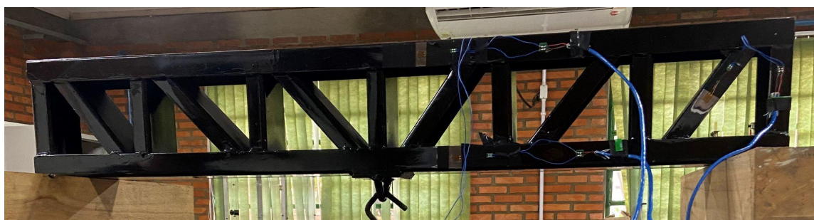
Figura 23 – Colagem dos extensômetros na estrutura treliçada.
