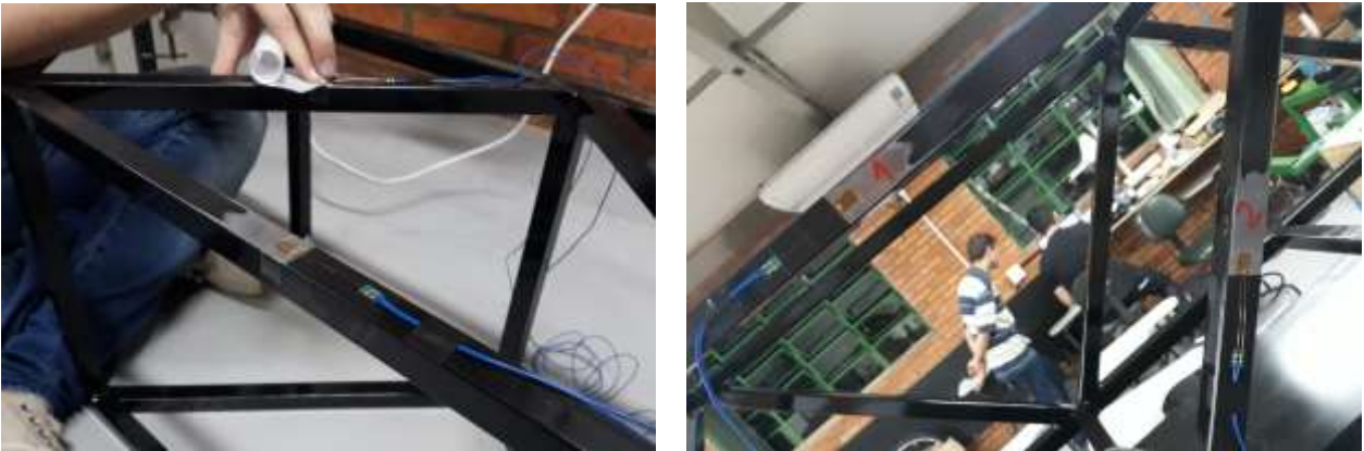
Figura 31: Tubos selecionados, preparação e colagem dos extensômetros.
