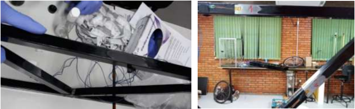
Figura 28 - Colagem dos extensômetros
