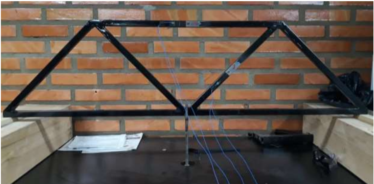
Figura 39: Treliça posicionada para a aquisição de dados.
