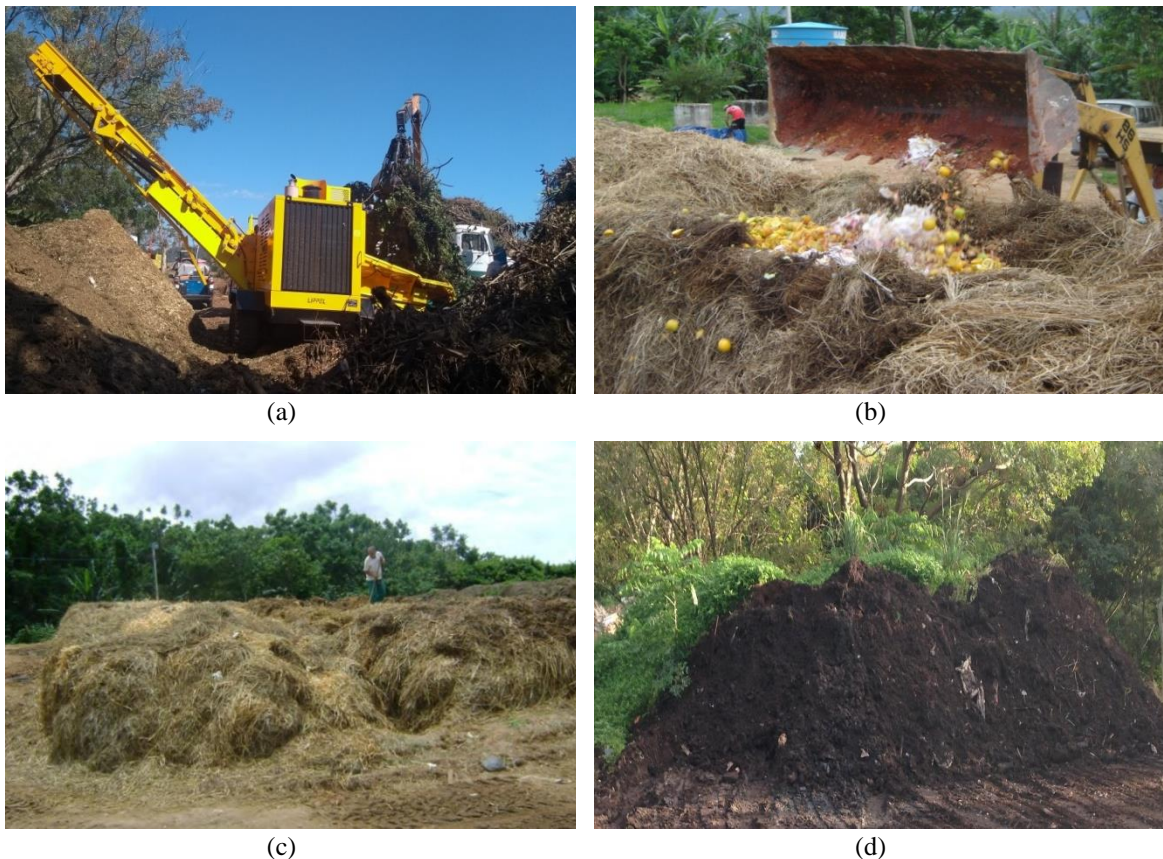
Figura 7 - Trituração dos resíduos verdes (a), montagem das leiras de compostagem (b e c) e pilha de composto orgânico em maturação (d)
