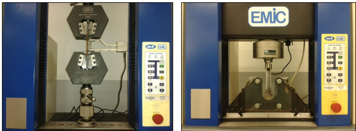
Figura 19 - Máquina de ensaios universal - a) tração, b) dobramento
