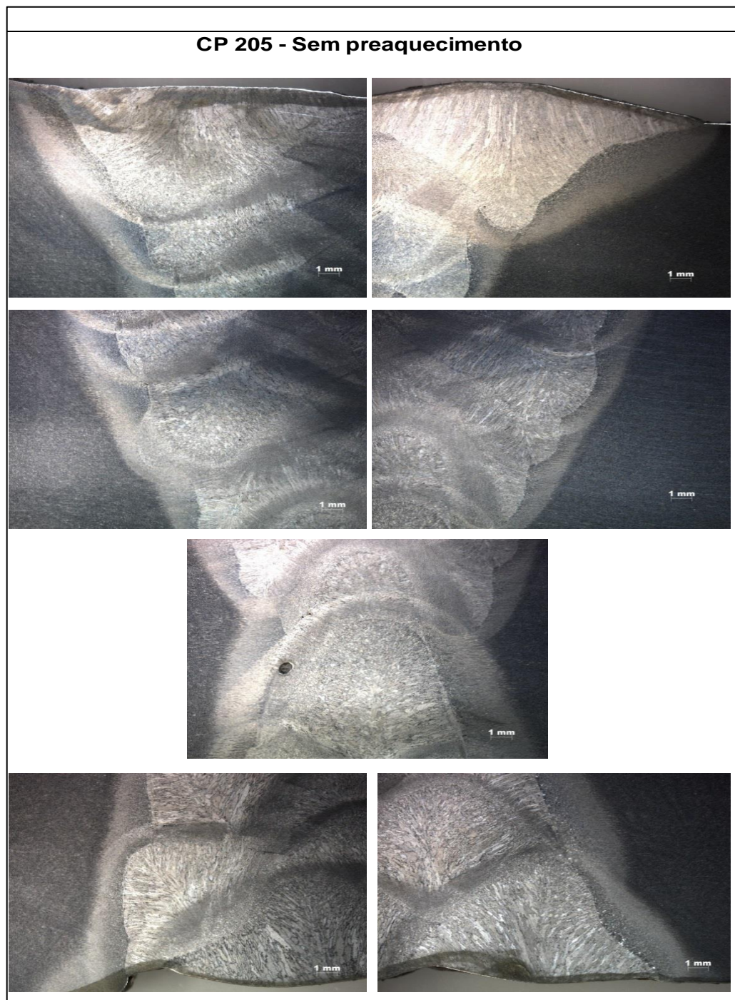
Figura 45 – Macrografia do corpo de prova CP 205 - sem preaquecimento
