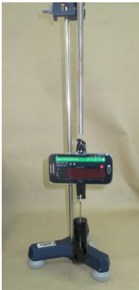
Figura 5: Imagem da configuração experimental projetada para medir as propriedades da constante elástica da mola usando o sensor acelerômetro do smartphone
