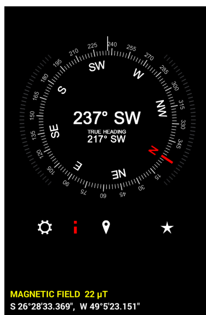
Figura 8: Tela do aplicativo “Bússola”. A direção do campo magnético é dada pela coloração avermelhada em cima do eixo que aponta para o norte. O número na parte inferior da imagem representa a intensidade do campo magnético em \mu\text{T}
