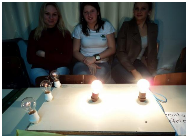
Figura 6: Circuito em série e em paralelo.
