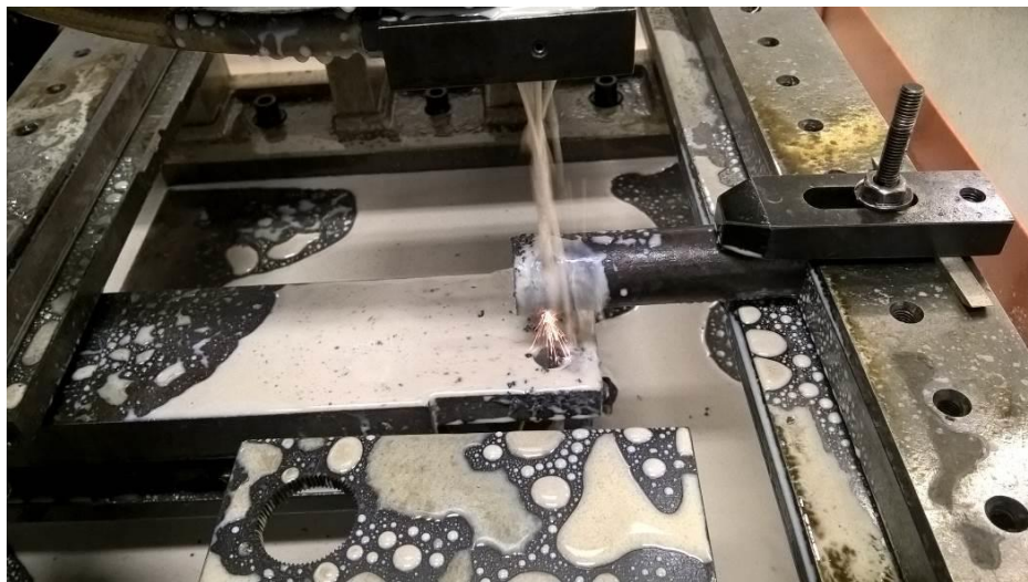
Figura 16 - Corte da barra no equipamento eletroerosão a fio
