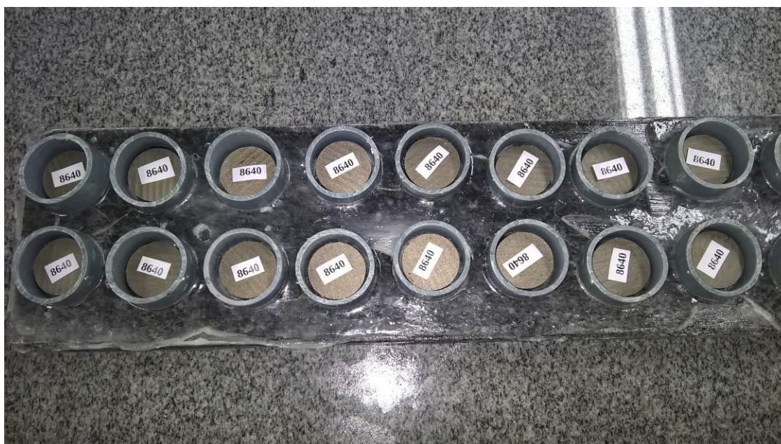
Figura 18 - Preparação dos moldes com as amostras identificadas
