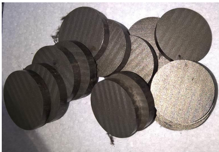
Figura 17 - Amostras do aço SAE 4140 seccionadas com espessura de 4mm
