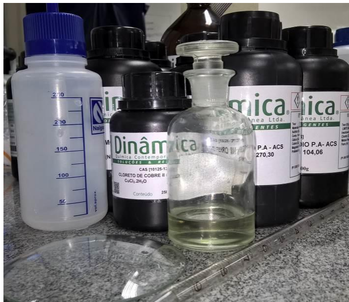
Figura 23 - Produtos utilizados nos reagentes e alguns frascos utilizados para o ataque químico
