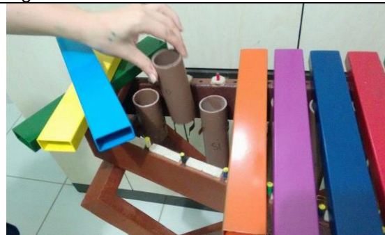
Figura 11- Vibrafone em montagem, no caso com o encaixe dos canos de PVC.
