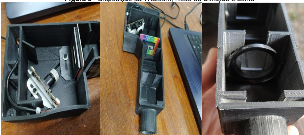
Figura 9 - Disposição da Webcam, Rede de Difração e Lente
