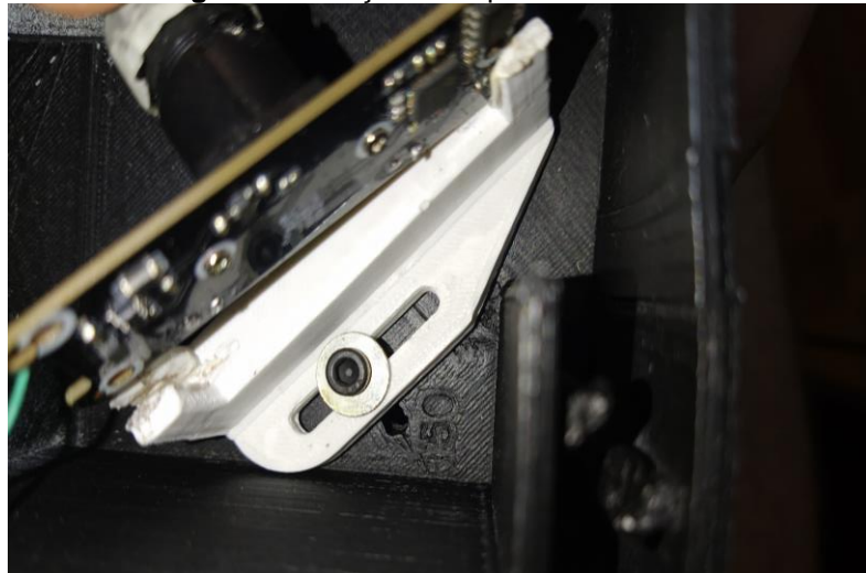
Figura 3 - Fixação do suporte na estrutura
