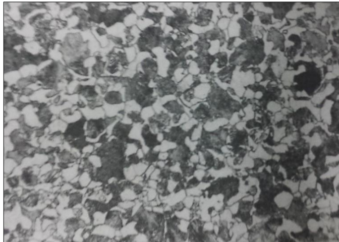
Figura 14 – Estrutura de aço carbono 0,45% C após resfriamento lento, ataque Nital e ampliação 430X
