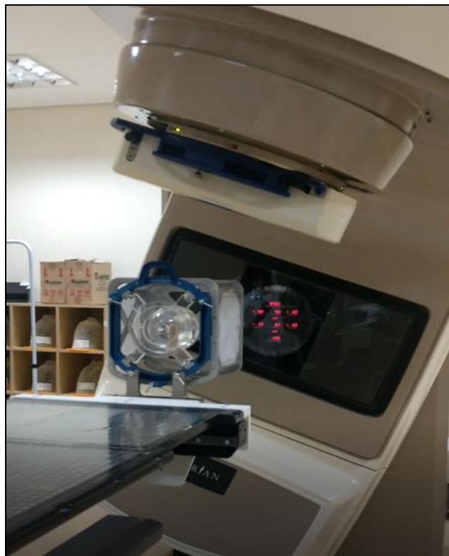
Figura 12 - Posicionamento do objeto simulador com a cubeta internamente no mesmo, fixado na mesa de tratamento no AL
