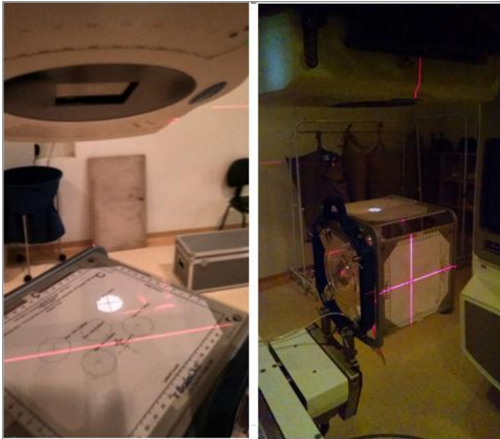
Figura 28 - Mapas de localização de coordenadas Estereotáxica, fixados na mesa com todo o conjunto da CI e objeto simulador, para irradiação de simulação
