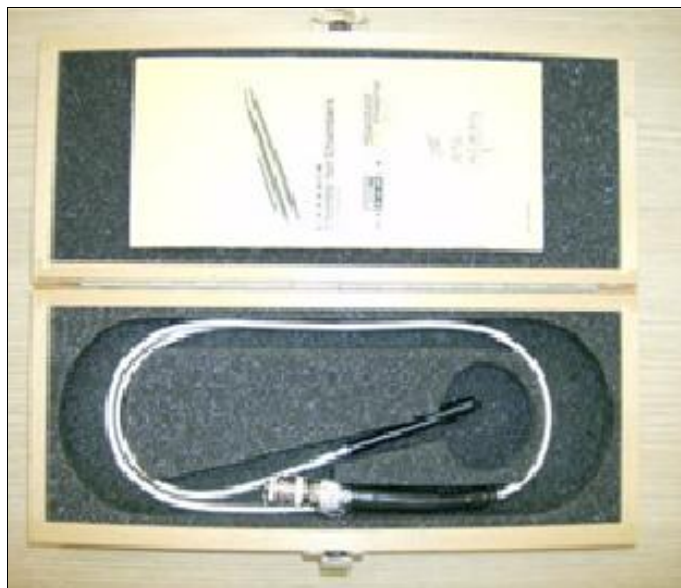
Figura 14 – Câmara de ionização modelo A 16, do CEPON
