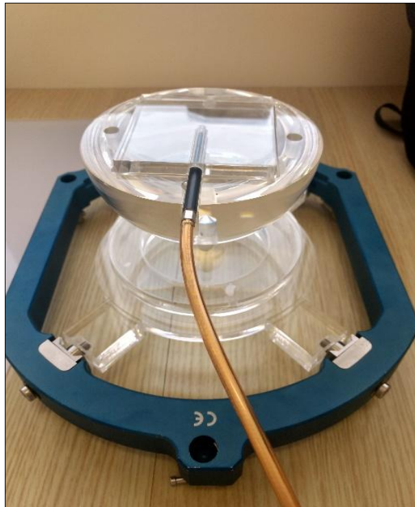
Figura 24- Objeto simulador com o encaixe interno e CI posicionada
