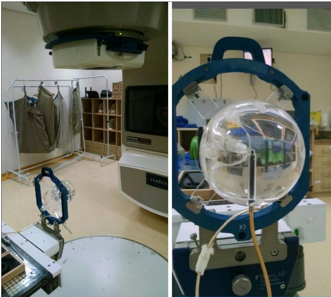
Figura 29 - Posicionamento do objeto simulador no AL para irradiação com a CI
