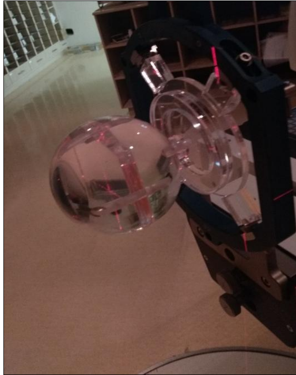
Figura 19 - Suporte de cabeça – objeto simulador fixado a mesa no AL
