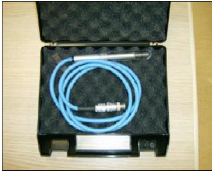
Figura 13 - Câmara de Ionização modelo Farmer, do CEPON
