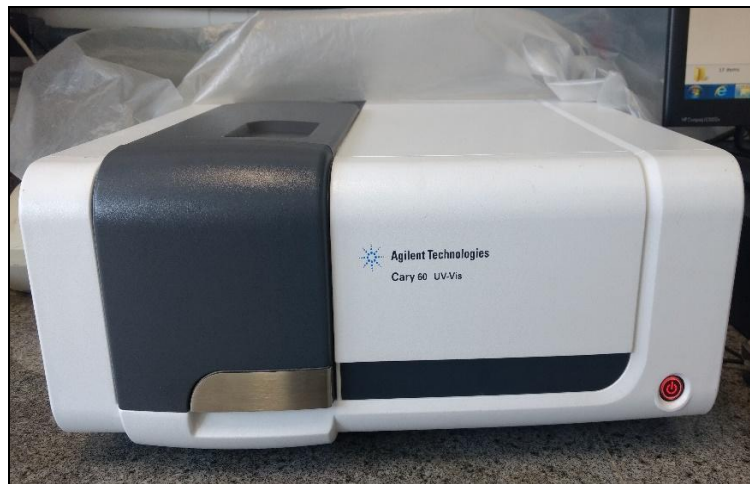
Figura 15 - Espectrofotômetro Agilent Technologies Cary 60-UV-Vis utilizado para leituras dos dosímetros
