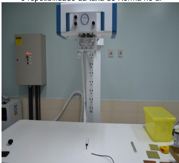
Figura 31 - Sistema de posicionamento (A), comando e coleta de dados para avaliação da linearidade e repetibilidade da taxa de Kerma no ar
