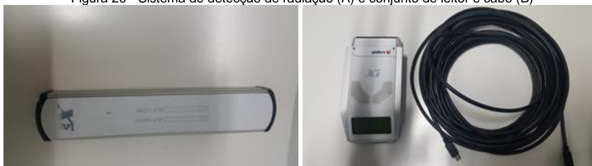
Figura 20 - Sistema de detecção de radiação (A) e conjunto de leitor e cabo (B)
