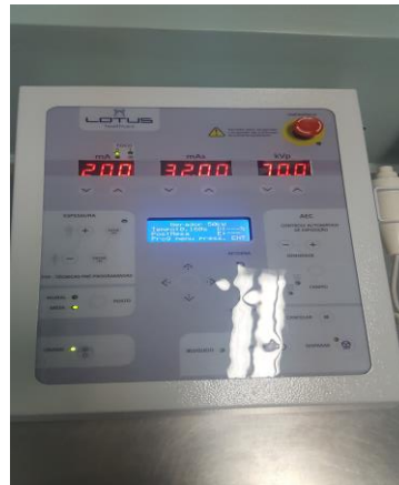
Figura 23 - Painel de comando do equipamento radiográfico indicando a técnica padrão
