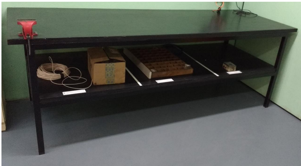
Figura 22 - Bancada demarcada com área de materiais em processo
