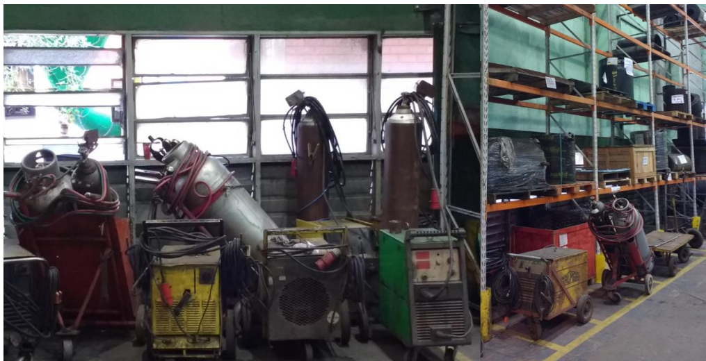
Figura 9 – Área de caldeiraria com máquina de solda e maçaricos em frente a paleteira dificultando o acesso aos materiais
