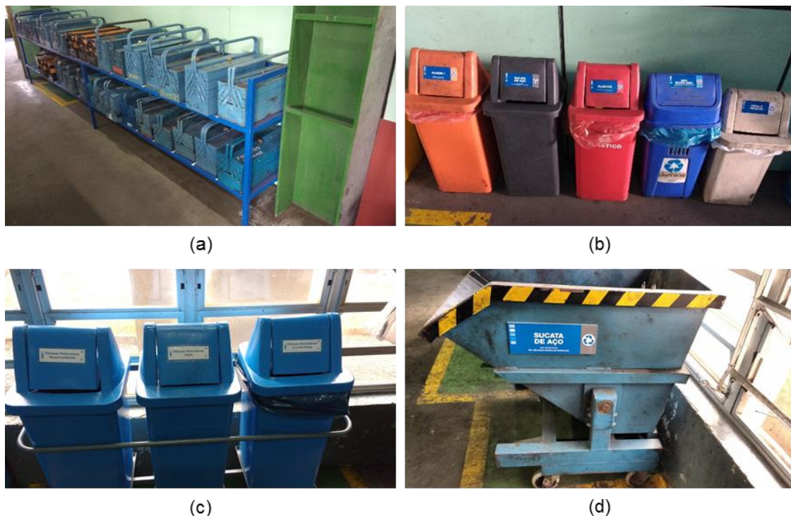
Figura 28 - Definição dos locais na oficina (a) acondicionamento das caixas de ferramentas (b) descarte de materiais (c) descarte de luvas (d) descarte de sucata de metal
