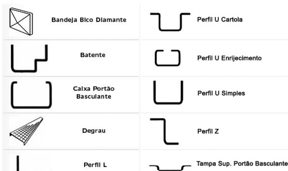
Figura 1 – Perfis passíveis de serem fabricados por dobra
