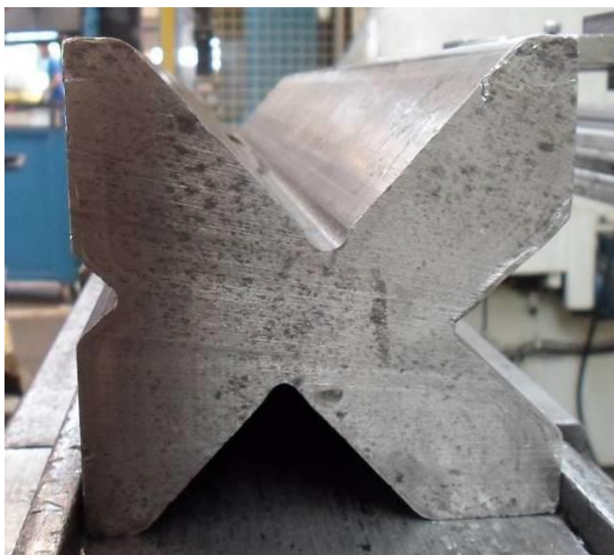
Figura 12 – Matriz de dobramento utilizado nos ensaios
