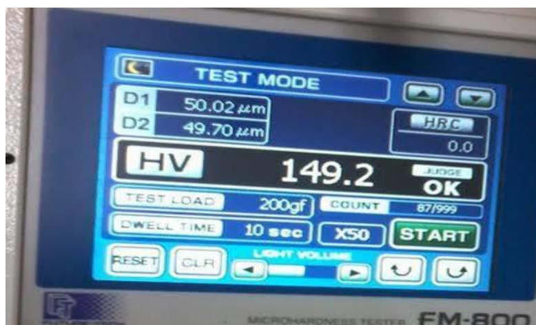
Figura 22 – Micro-dureza do aço antes de sofrer a deformação
