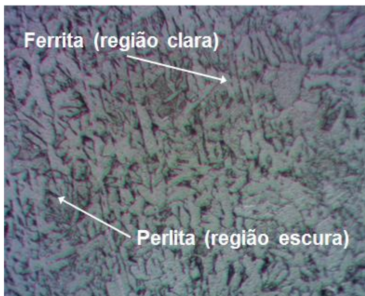
Figura 21 – Ensaio metalográfico do aço antes de sofrer a deformação
