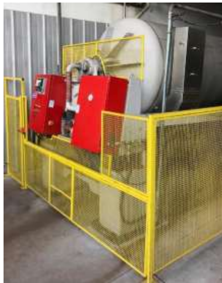
Figura 6: Prensa pneumática com capacidade para 30.000kg, marca DIEMME
