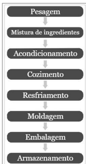
Figura 1. Fluxograma das etapas de produção das barras de cereais salgadas adicionadas de açafraão-da-terra
