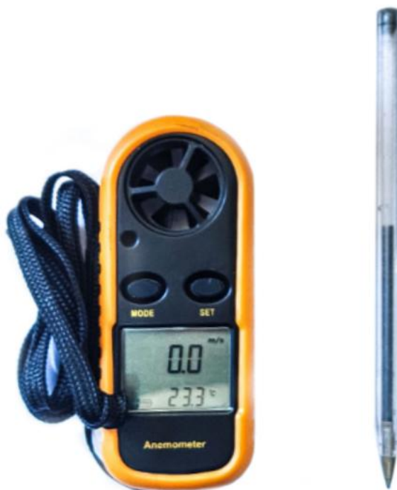
Figura 12 - Da esquerda para a direita: Anemômetro e caneta esferográfica para fins de escala
