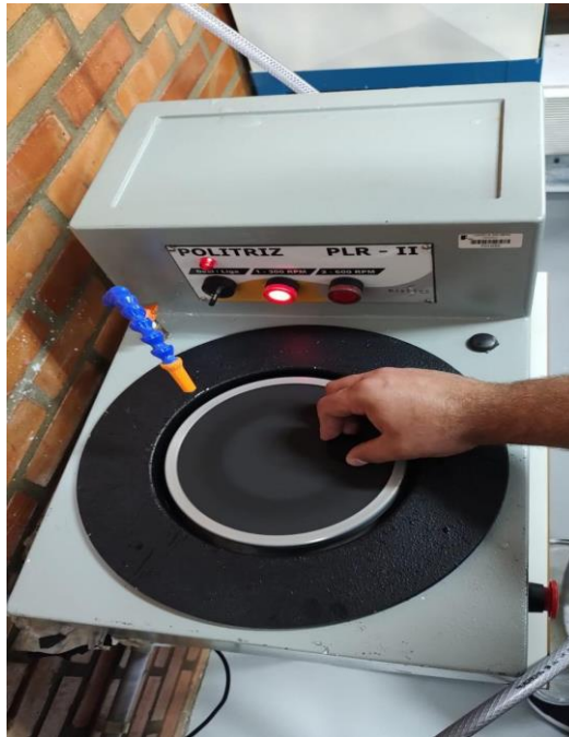
Figura 20 - Processo de lixamento na politriz
