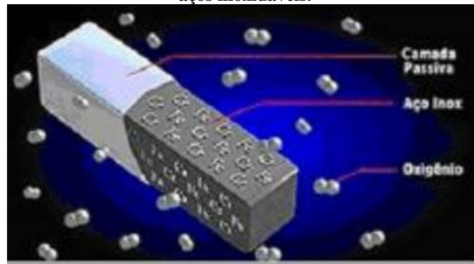
Figura 15: Camada passiva formada sobre a superfície dos aços inoxidáveis.
