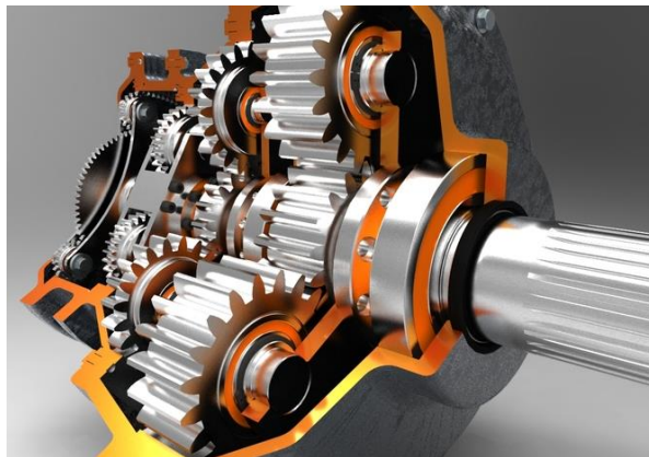
Figura 5 - Redutor planetário com quatro estágios e três engrenagens planetárias
