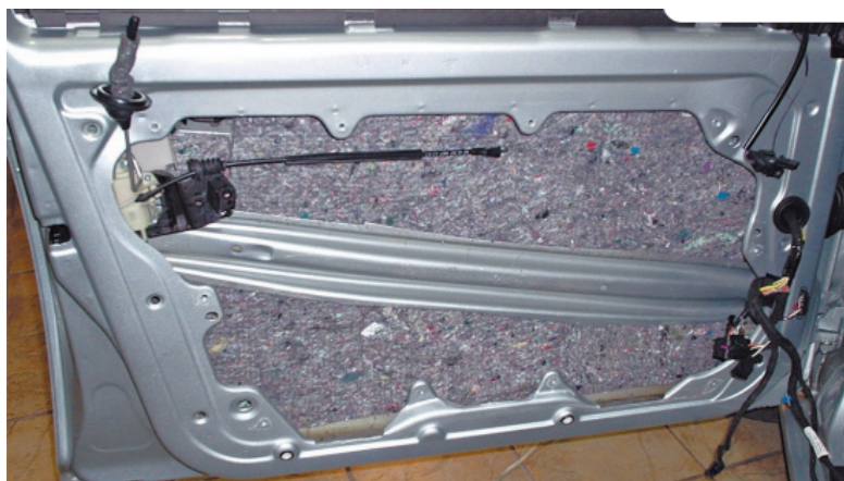
Figura 8: Revestimento acústico na porta de um carro.
