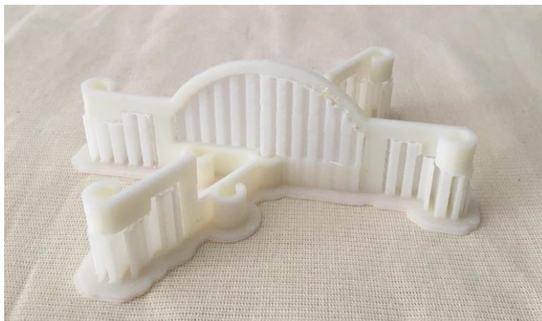
Figura 65: Modelo Impresso com apoios, sem acabamentos especiais
