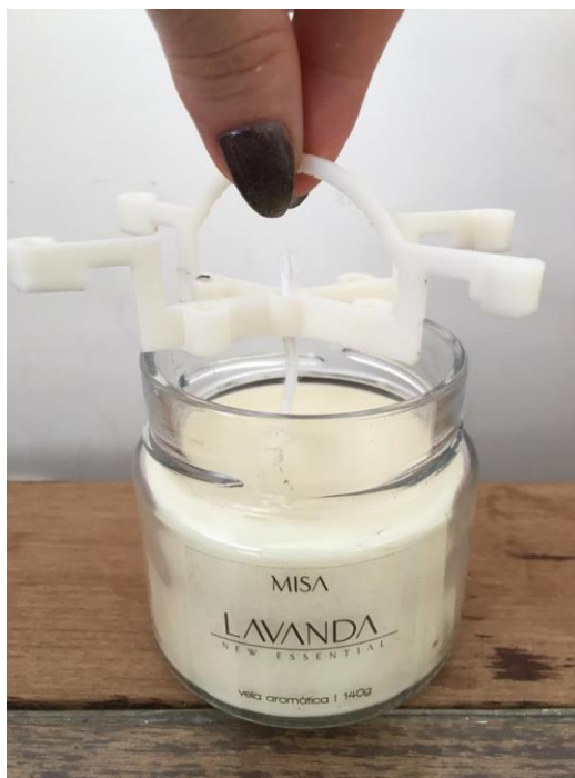
Figura 61: Haste para manipulação, com a vela já fria e adesivada.
