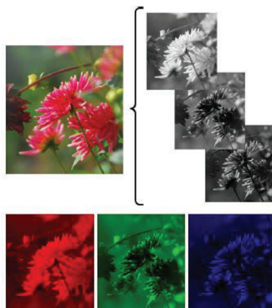
Figura 9 – Imagem colorida constituída de três planos de cor: vermelho, verde e azul
