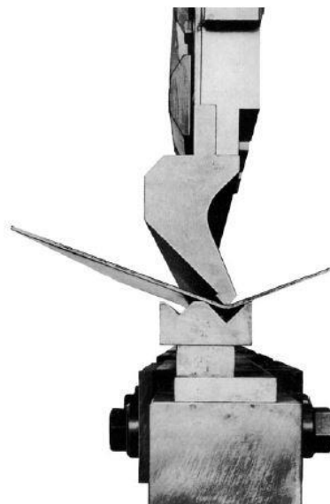
Figura 13 - Processo de dobramento em V utilizado no estudo
