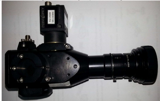
Figura 15 – Cabeçote de medição por shearografia modelo N4F
