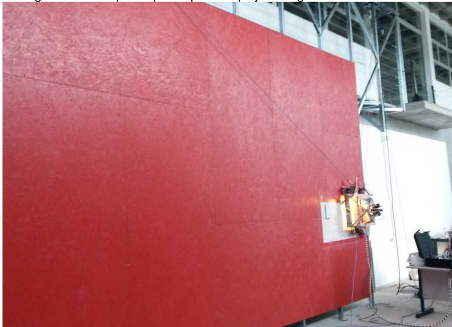
Figura 14 – Corpo de prova para inspeção de grandes áreas verticais
