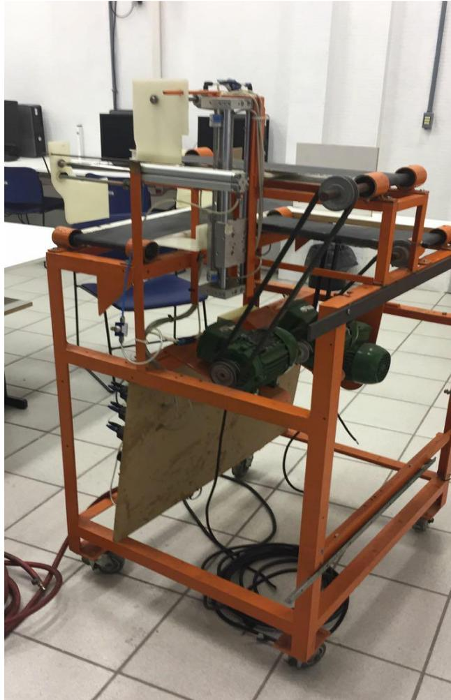
*Figura 5- Máquina de triagem de peças*
