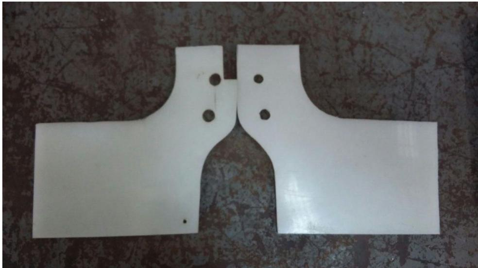
*Figura 25- Anterior x Novo puxador do cilindro da esteira superior*
