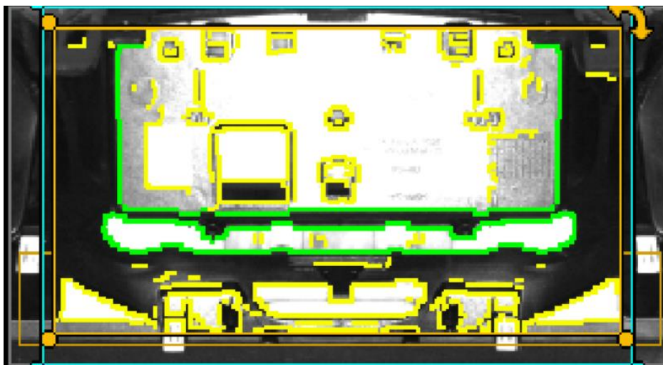
Figura 50 – Aplicação da ferramenta de resumo para selecionar o contorno do formato 3.
