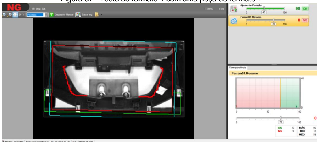
Figura 57– Teste do formato 4 com uma peça do formato 1
