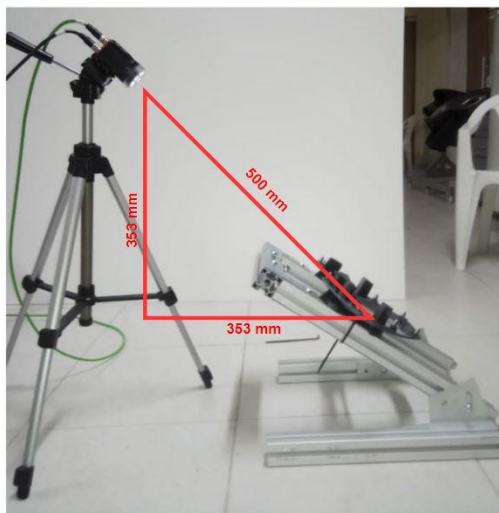
Figura 6 - Posicionamento do sensor de visão.
