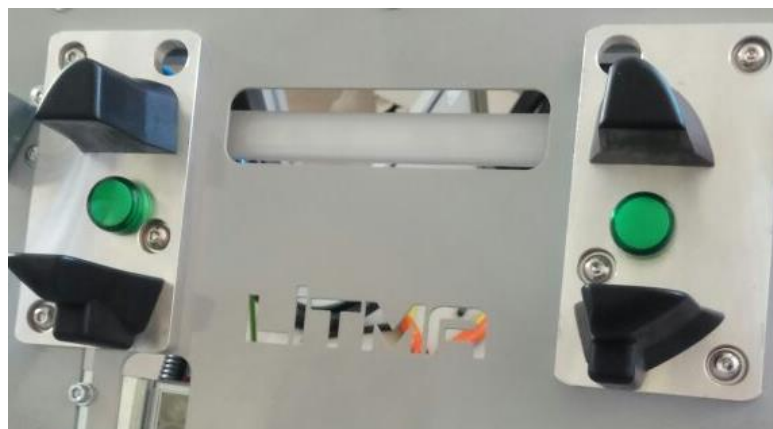
Figura 24 - Instalação do indexador no berço.
