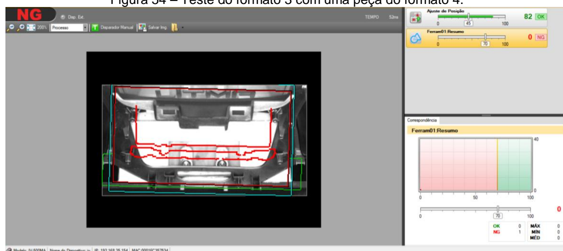
Figura 54 – Teste do formato 3 com uma peça do formato 4.
