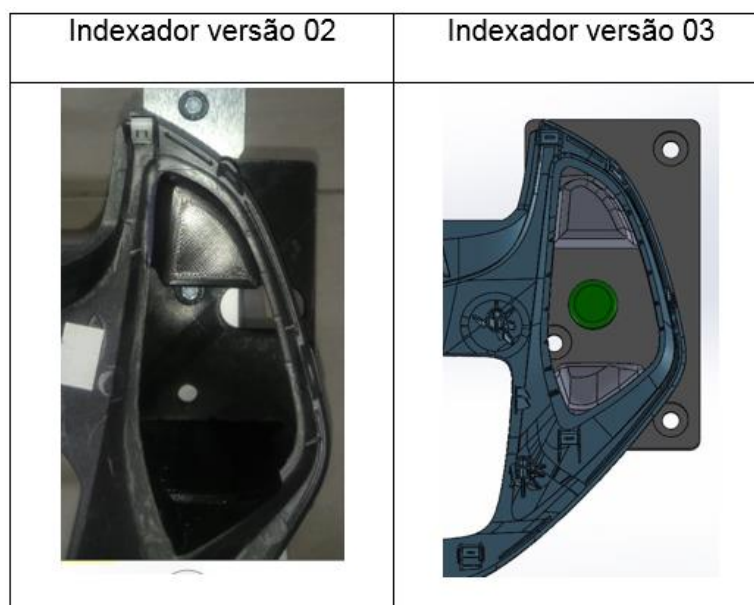
Figura 21 - Diferenças entre as versões dois e três dos indexadores
