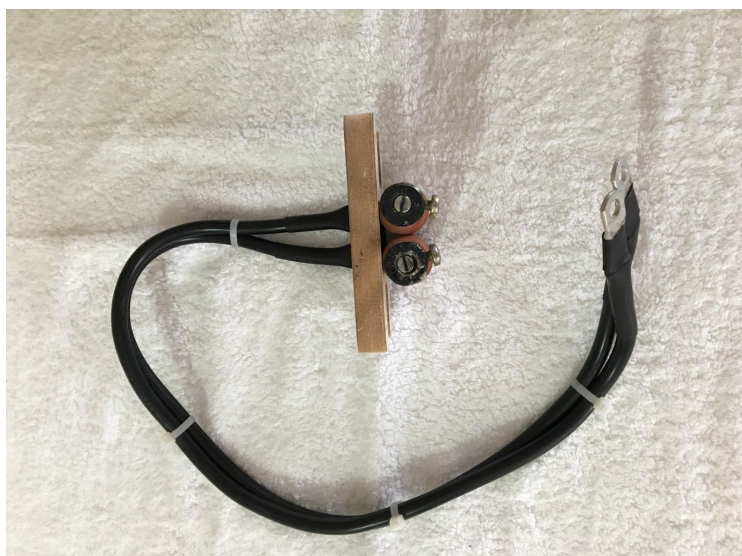
Figura 15 - Cabo de alimentação 25mm 2 com isolamento de Celeron
