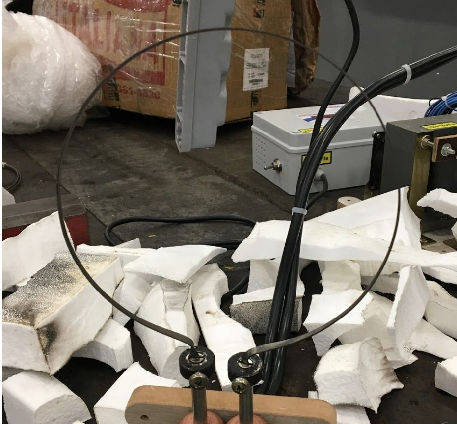
Figura 21 - Deformação do filamento resistivo
