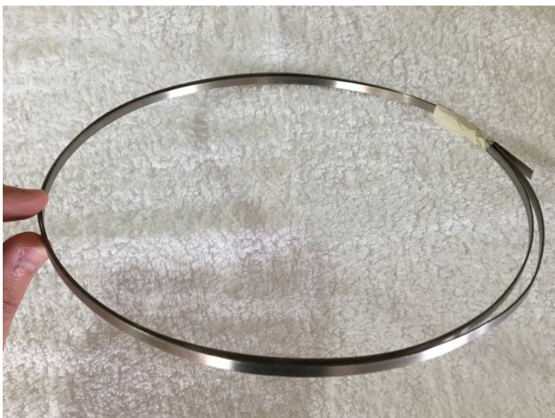
Figura 16 - Elemento resistivo tipo fita níquel cromo
