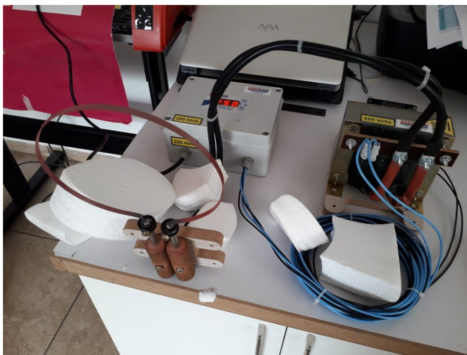
Figura 17 - Modelador de EPS Acryflon ligado
