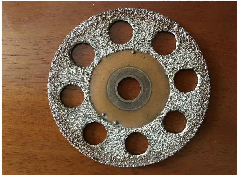
Figura 9 - Disco de corte abrasivo da SRS Surfboards
