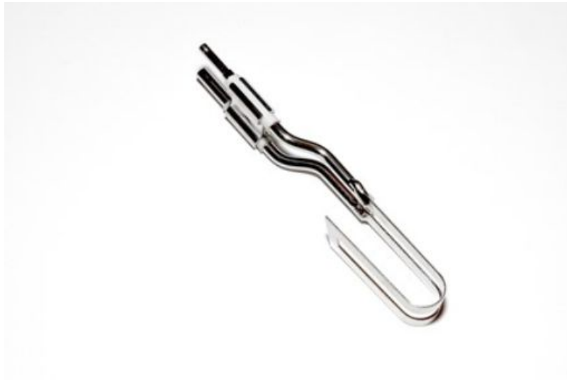
Figura 6 - Lâmina HSGM para reprodução análoga ao disco de corte
