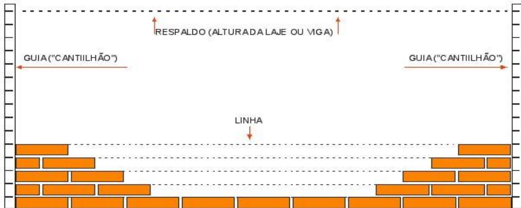
Figura 8 – Execução de parede em alvenaria.
