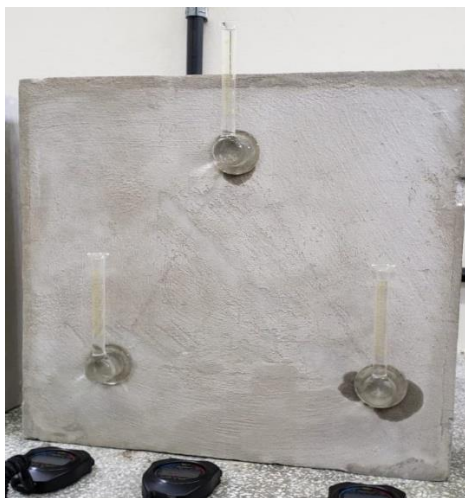
Figura 22 – Manchas de umidade presentes em paredes do Grupo 1 nos primeiros 10 minutos de ensaio do cachimbo.
