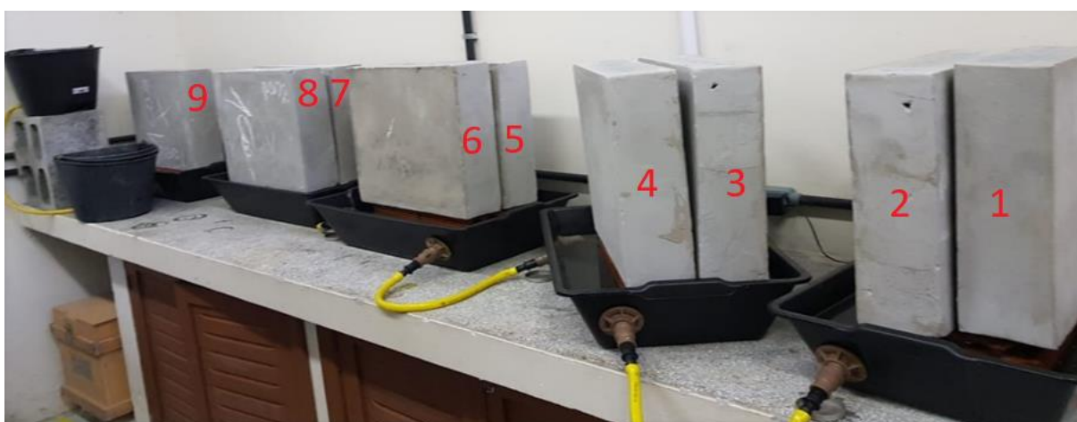
Figura 19 – Paredes sobre sistema de umidade.
