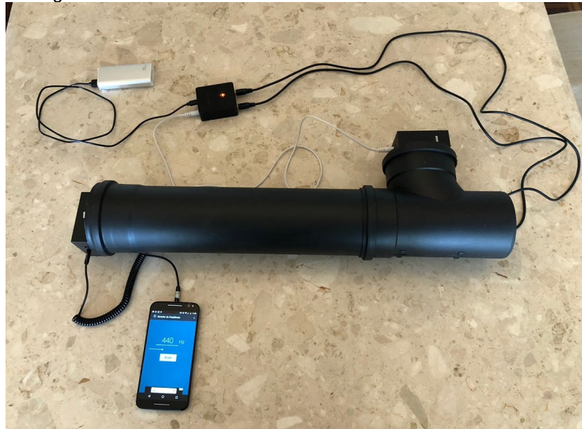
Figura 41 - Sistema de testes controlado usando tubos de PVC.
