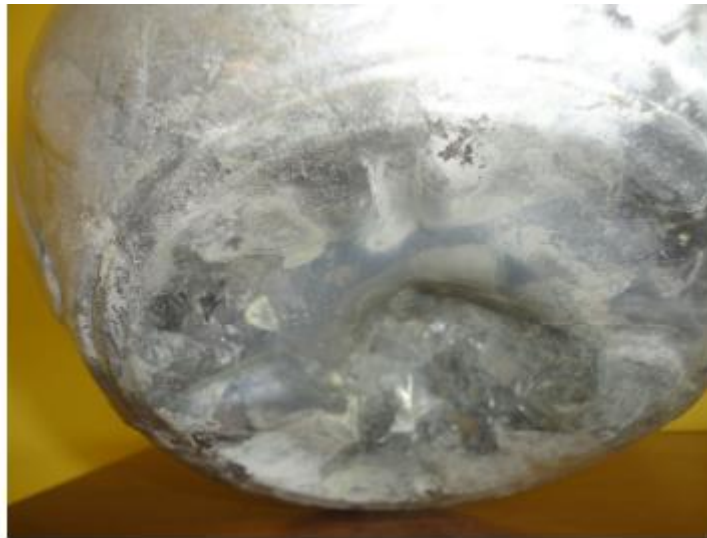
Figura 2: Óxido de chumbo produzido a partir do armazenamento das lâminas.
