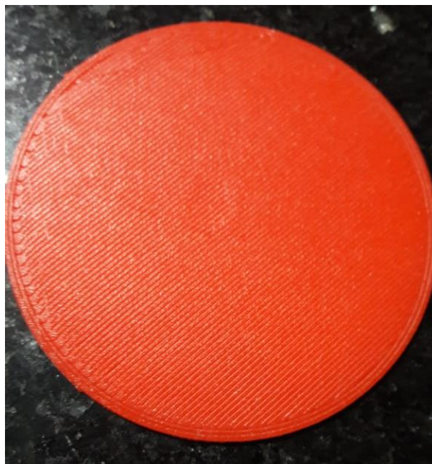
Figura 10: Círculo de ABS após exposição ao hipoclorito de sódio.
