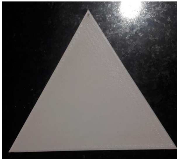
Figura 8: Triângulo de ABS depois de ser exposto ao produto desinfetante.
