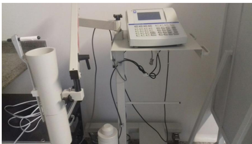
Figura 8: Probe para captação de tireoide.
