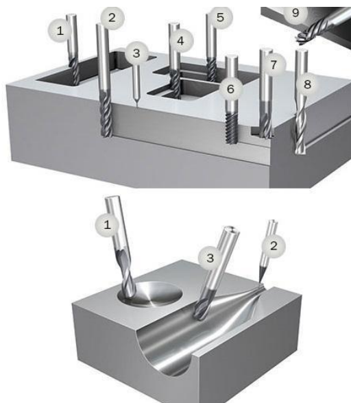
Figura 2 - Aplicações das fresas de metal duro reto e esférico
