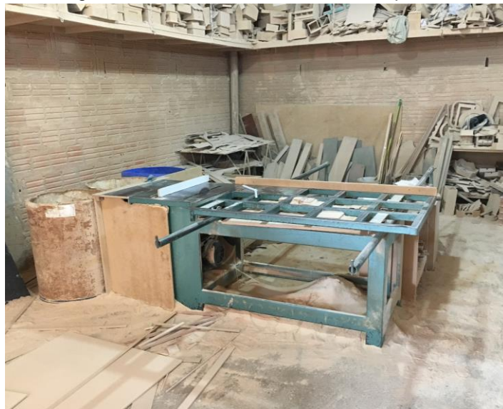
Figura 6 - Serra circular utilizada na empresa.
