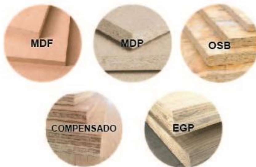
Figura 4 - Tipos de painéis de madeira.
