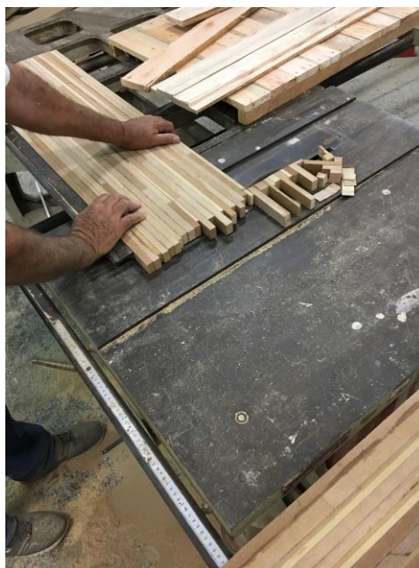
Figura 41 - Esquadreamento da peça do tampo.
