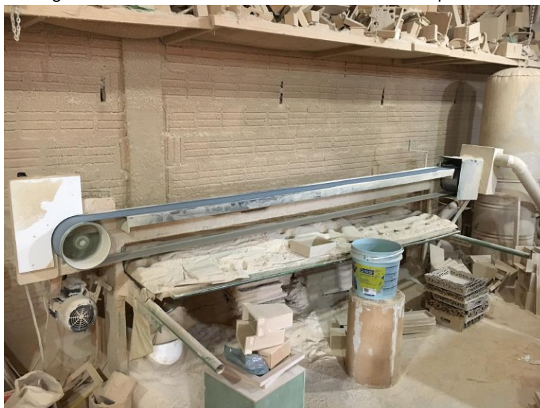
Figura 9 - Lixadeira utilizada no acabamento dos produtos.
