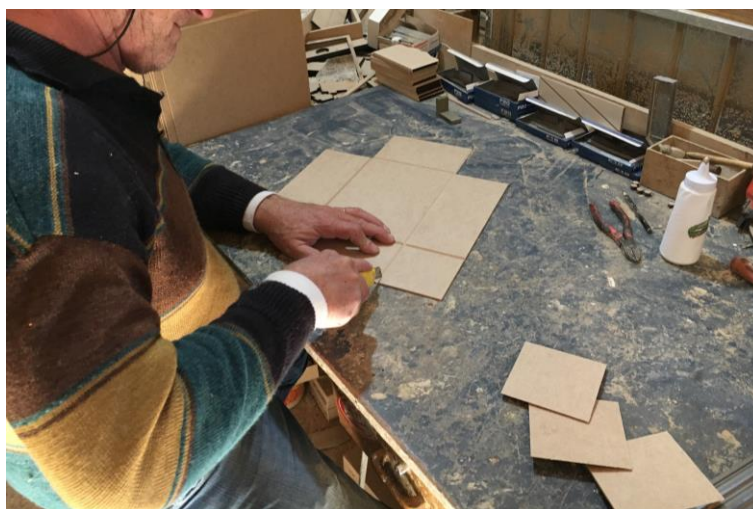
Figura 13 - Processo de montagem caixas tipo sapato 3mm.
