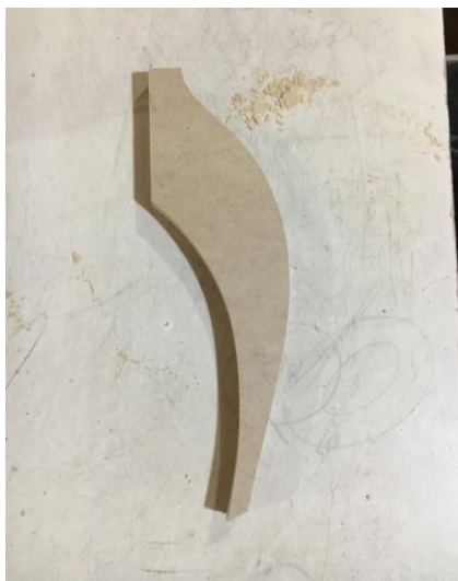
Figura 14 - Refugo proveniente de corte para pés de aparador.
