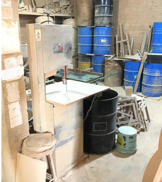
Figura 7 - Serra fita utilizada na fabricação de produtos na MD artesanato.
