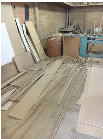
Figura 10 - Retalhos com largura reduzida (sarrafos) provenientes dos cortes primários.
