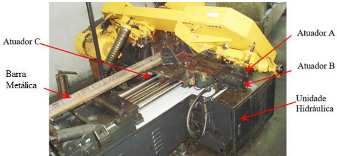
Figura 01 - Serra fita para o corte automático de tarugos.
