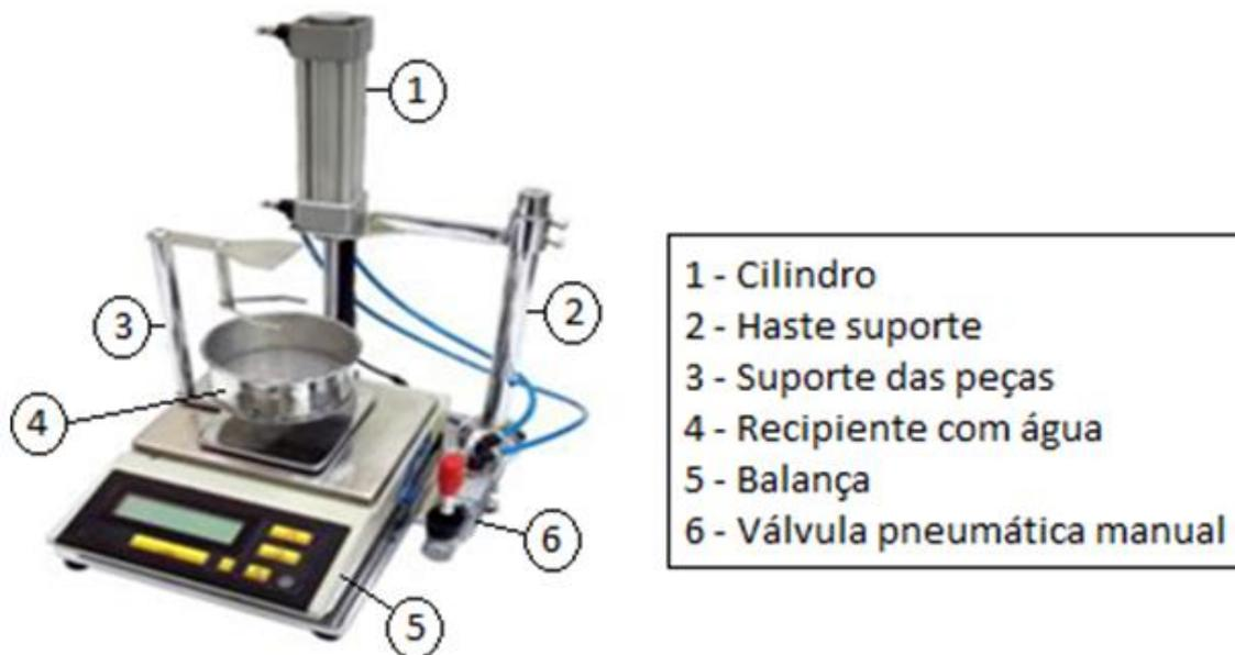
**FIGURA 9 - Equipamento para determinação de densidade aparente**
