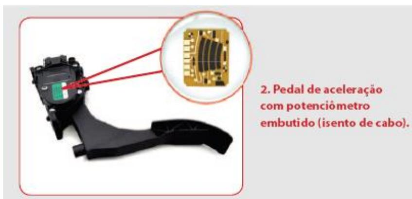
Figura 3. 8 pedal acelerador e potenciômetro. Fonte Informativo técnico DS.
