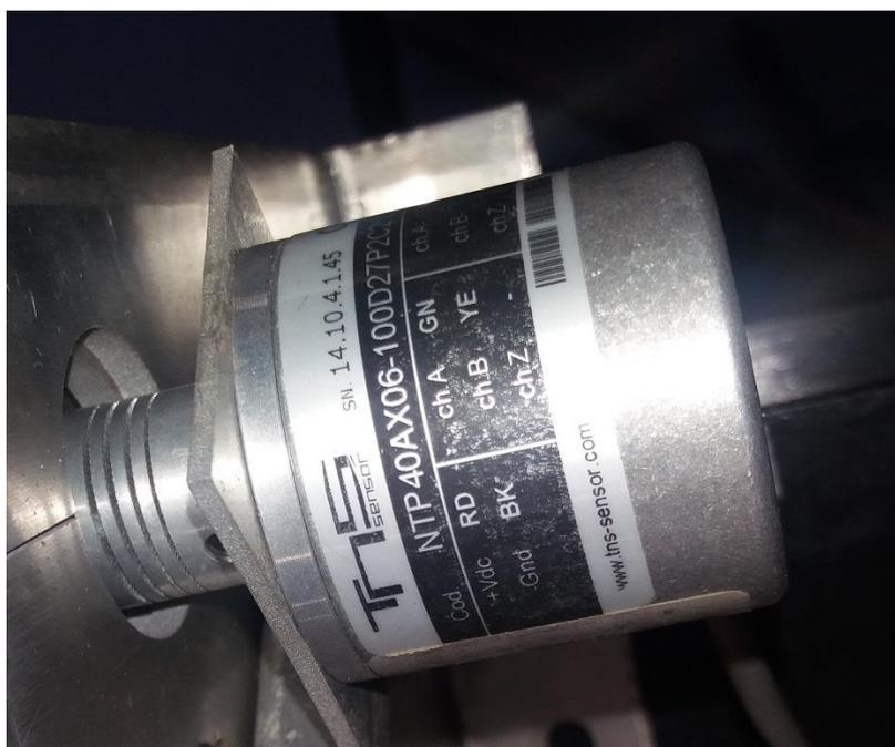
Figura 3. 10 Encoder relativo de 100 pulsos.
