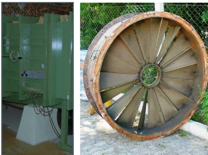
Figura 2. 9 Sistema de controle de velocidade por bloqueio através de aletas (Fonte: Custódio, 2010)
