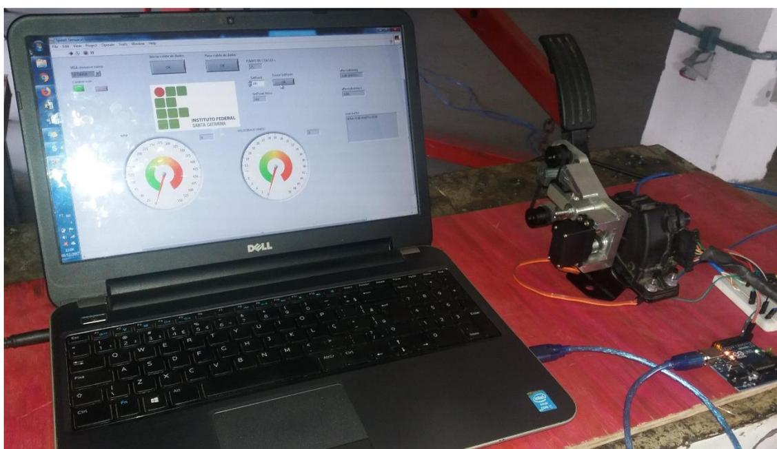
Figura 4. 6 Instalação para testes de comunicação entre sensores, servo e arduino.
