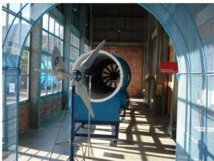
Figura 2. 8 Teste de turbina eólica em túnel de vento. (Fonte: Alé, 2010).
