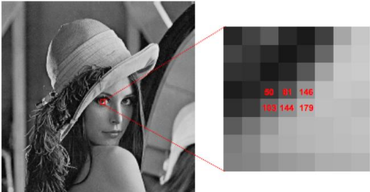
Figura 4 - Exemplo de uma imagem digital e intensidade de alguns dos seus pixels.
