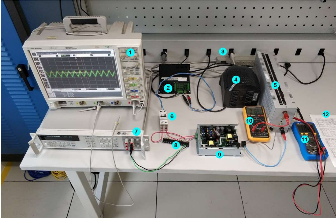
Figura 20. Bancada de testes para procedimento manual. Fonte sob teste DWPS60_v01. Fonte: Próprio autor
