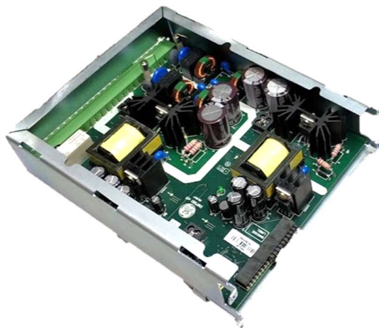
Figura 19. Fonte DWPS60_v01. Fonte: Imagem cortesia GE
