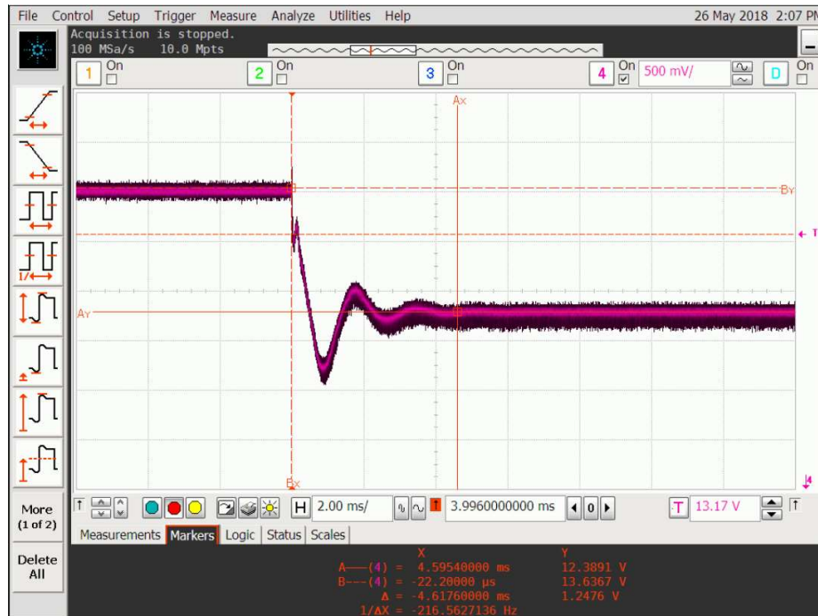
Figura 36. Resposta dinâmica para 48 V cc e 100% de carga, teste manual fonte SFF48LDC_v02. Fonte: Próprio autor
