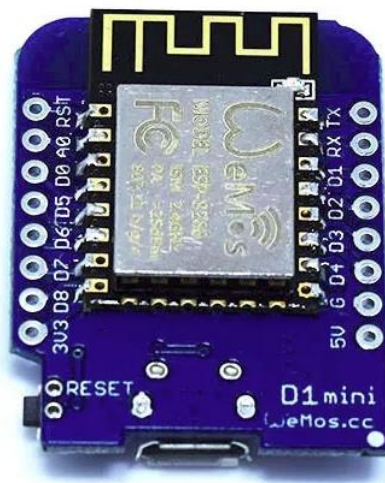
Figura 5 – Kit de desenvolvimento Wemos D1 mini.
